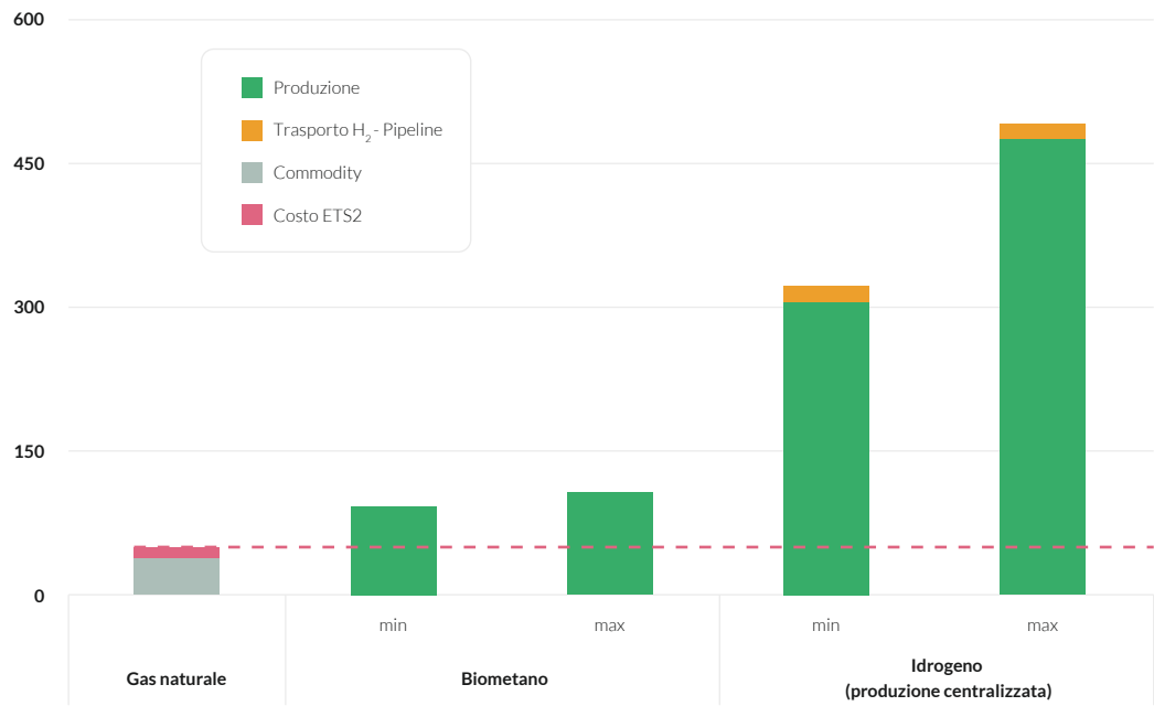
Figura 3.9: Confronto tra prezzo del gas naturale 1 e LCOE di biometano 2 , e idrogeno rinnovabile 3 [€/MWh] (per il gas naturale si è ipotizzato un prezzo delle EUA per l'ETS 2 pari a 65 €/tCO 2 eq.)
